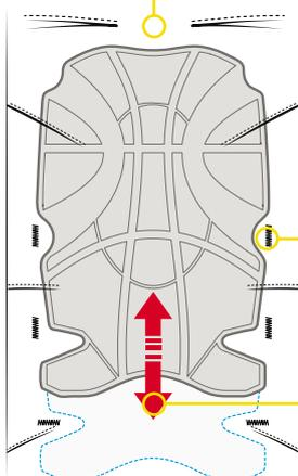
Sechs Riegel fixieren den Knieschoner, zwei in der Höhe und vier für einen optimalen, mittigen Sitz.
